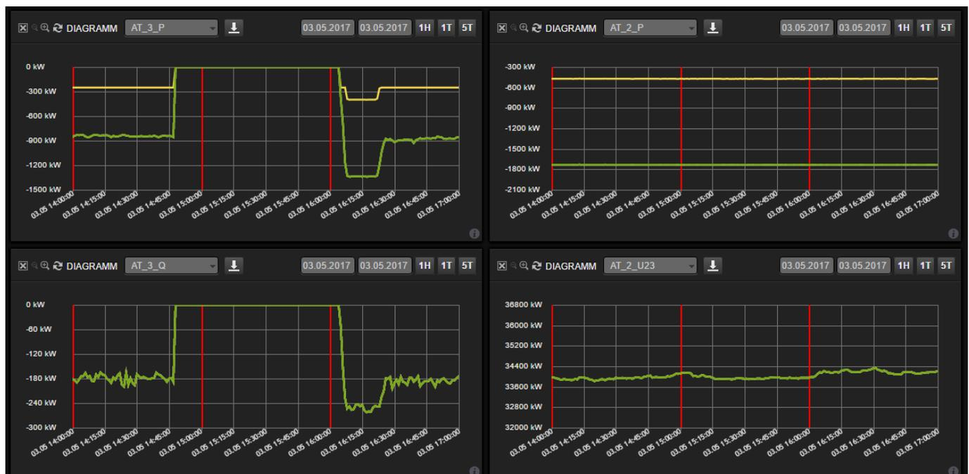
Abbildung 38: Screenshot einer Vollabschaltung an einem von zwei Einspeisern am selben Einspeisepunkt.
