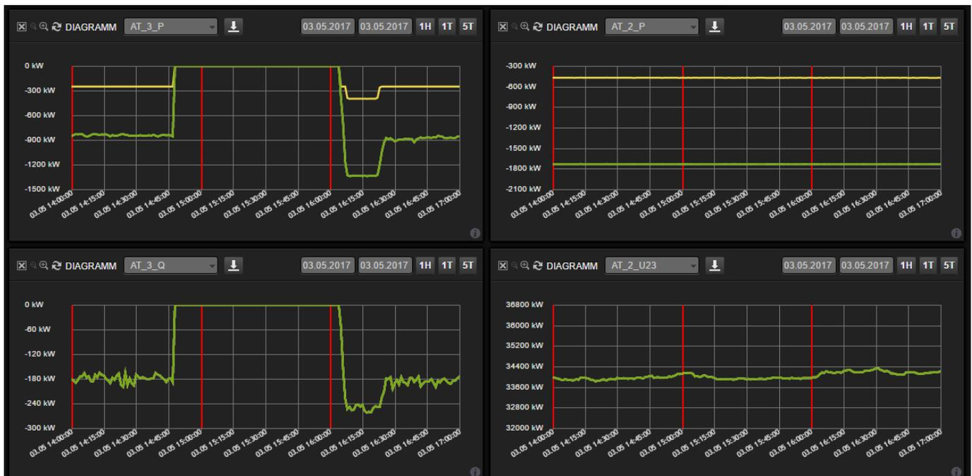
Abbildung 17: Screenshot einer Vollabschaltung an einem von zwei Einspeisern am selben Einspeisepunkt.
